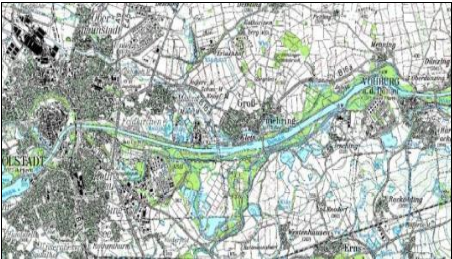
Abb.1b: Donau zwischen Ingolstadt und Vohburg heute. Die Begradigung und Abtrennung von Schleifen und Verzweigungen erfolgte bereits durch die Mittelwasserkorrektion
